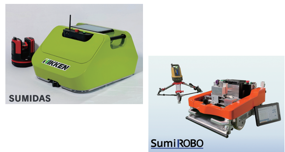
図6 墨出しロボット
