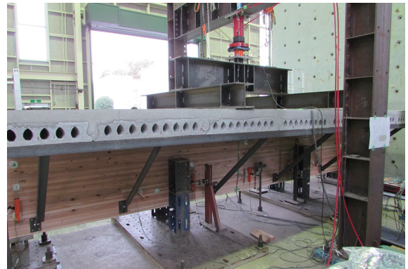
写真2 合成梁実験の様子
