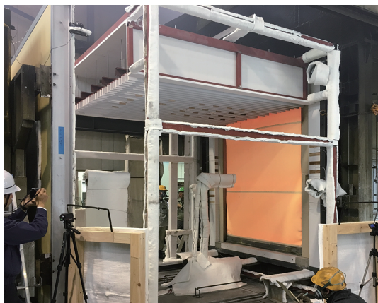
写真6 木+耐火スクリーン実験の様子
