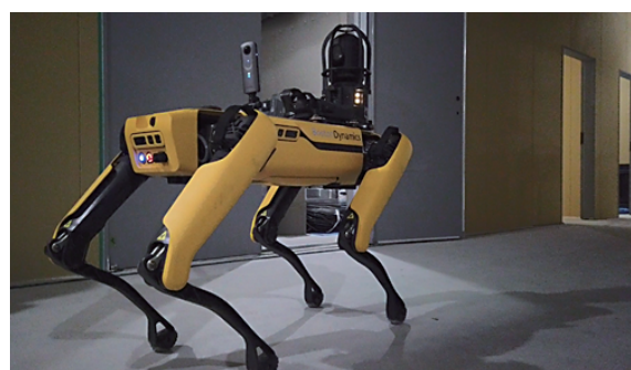
図7 工事現場内での四足歩行型ロボット実証の例
