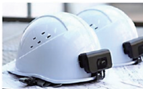
図8 センサデバイスをヘルメットに装着した例
